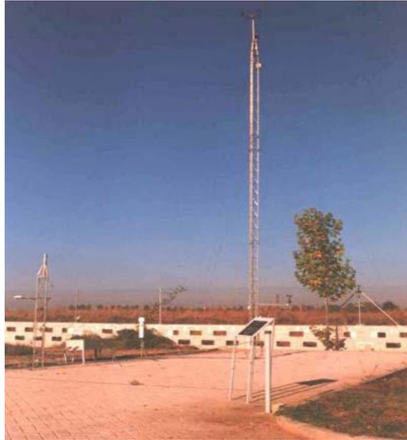
Figura 6.- Torre meteorológica en lo alto de la cual se ubican los dispositivos de medida
