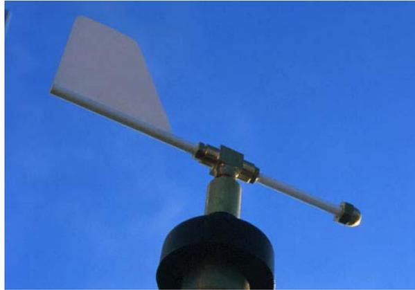
Figura 4.- Veleta: medición de la dirección del viento [1]
