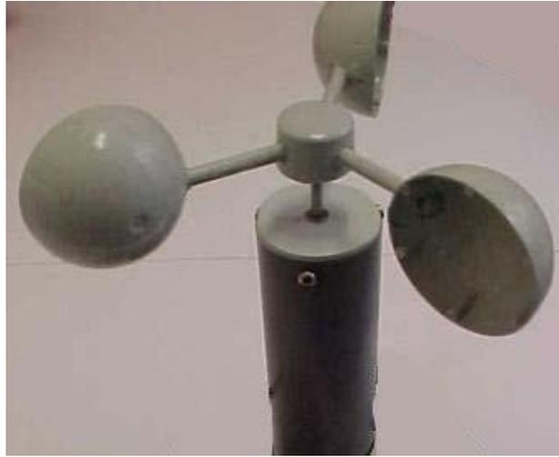
Figura 5.- Anemómetro de cazoleta [1]
