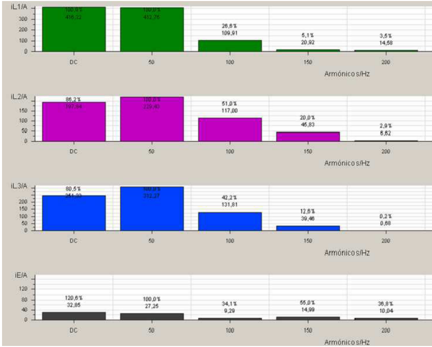
Figura 6.2: Análisis espectral para oscilograma de la fig. 6.1. Escalado vertical en valores primarios. Escalado horizontal en Hz.
